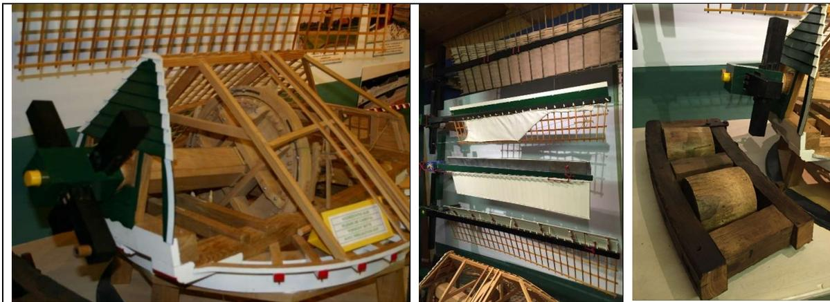
Il est important que le moulin fait face au vent. Pour faire pivoter, le meunier gire le rouet principal. Ici est le câble avec un crochet. Le meunier accroche le câble derrière une poutre de support du rack.
