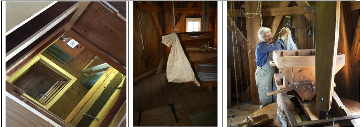
El grano se introduce en un agujero en la piedra superior a través de la tolva (en el marco de molino). El molinero coloca el eje de piedra a la rueda dentada cilíndrica alrededor del eje principal. El husillo está conectada con la piedra superior, la piedra corriente. Es lógico pensar que el molino no funciona cuando se hace esto.
