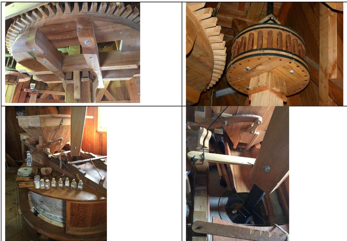
Das Gate unter dem Trichter geöffnet wird und das Korn fällt in den Füllschuh. Da der Platz Pol Drehen der Zuführschuh Shakes. Das Korn fällt in die "Auge" oder Mittelloch und landet zwischen der Lauf Stein und dem Bett aus Stein. Die Steine haben Furchen durch die das Mehl transportiert und gemahlen. Eine Art Besenchen wird zur Laufstein befestigt ist, so dass das Mehl fällt in die Rinne neben der Steine. Die Rinne transportiert das Mehl auf die Mahlzeit Sack auf den Boden unten.
