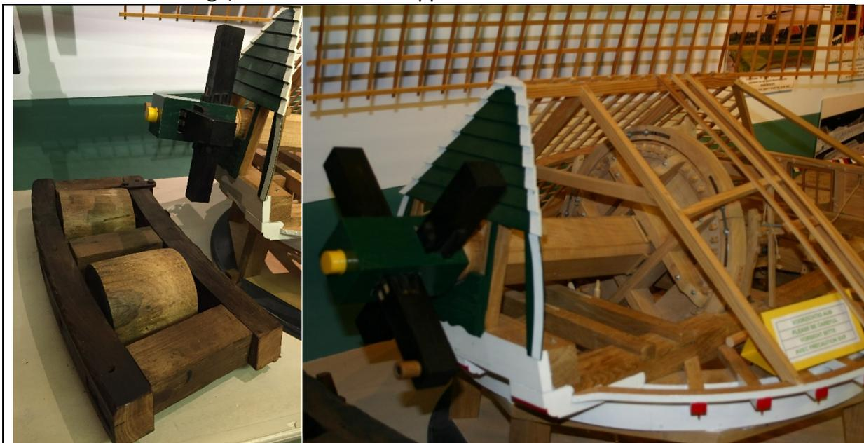
Die Segel werden mit dem Wind Welle verbunden ist, in diesem Modell aus Holz, aber in vielen Mühlen aus Gusseisen. Bremsrades mit der Hauptwelle verbunden ist, kann gesehen werden.
