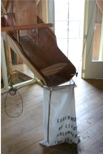
Das Mehl fällt in den Mehlsack und wenn er voll ist, wird ein neues Geschäft in Position gebracht zu besetzen. Durch die Holzfalltüren erreichen die Säcke im Erdgeschoss.
