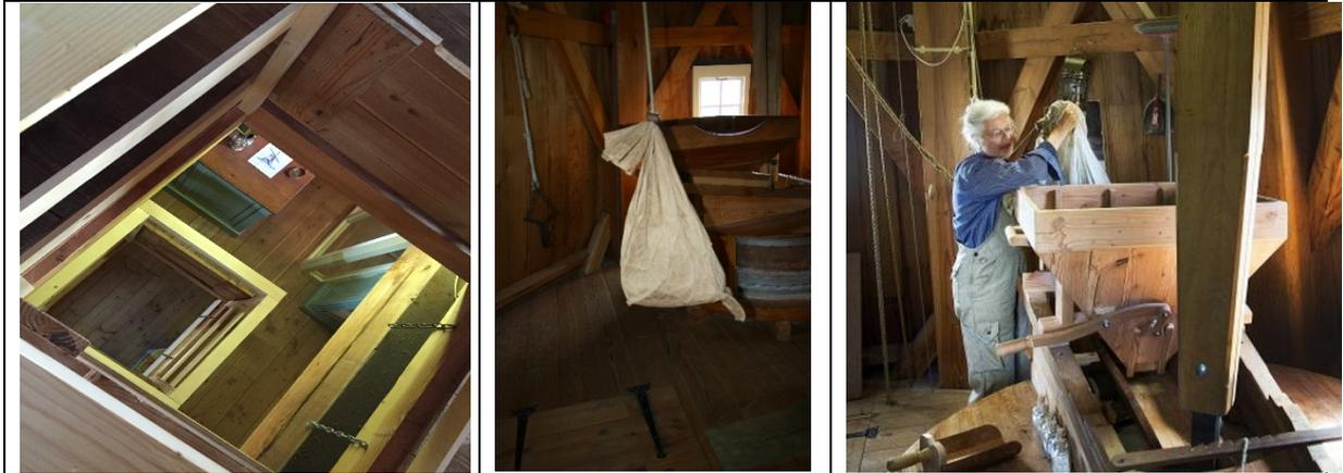
Le grain est introduit dans un trou de la pierre à travers la trémie supérieure (sur le bâti du broyeur). Le meunier place la broche de pierre contre la roue droite autour de l'arbre principal. La broche est connectée avec la pierre supérieure, la pierre en cours d'exécution. Il va de soi que le moulin ne fonctionne pas quand cela est fait.
