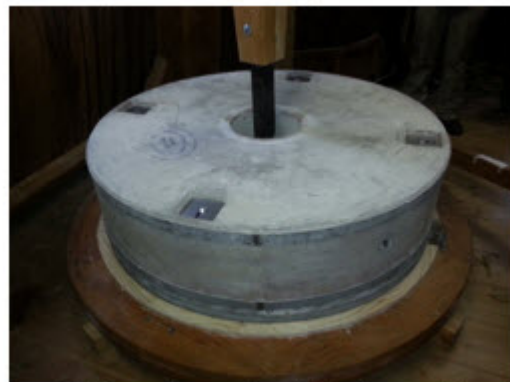
Het maalkoppel met de steenspil
